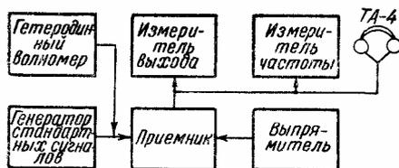
Рис. 27. Блок-схема измерения полосы пропускания приемника.
