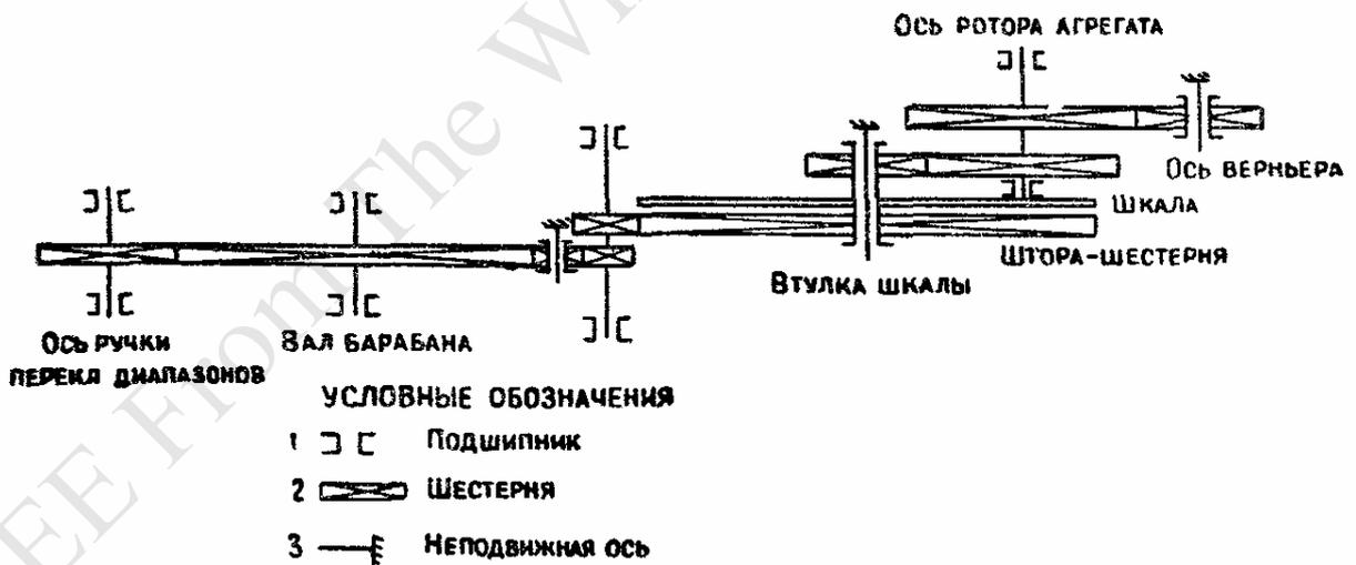
Рис. 24 Кинематическая схема элементов переключения и настройки
