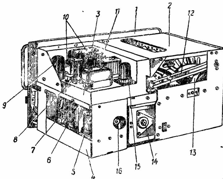
Рис. 15 Вид радиоприемника без кожуха.
