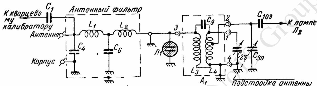
Для защиты входной цепи от высоких напряжений радиочастоты применен неоновый разрядник типа МН-3 ( $\Pi_1$ ), включенный параллельно антенной катушке  $L_3$ . При напряжении 50—60 в разрядник срабатывает и закорачивает вход приемника.
